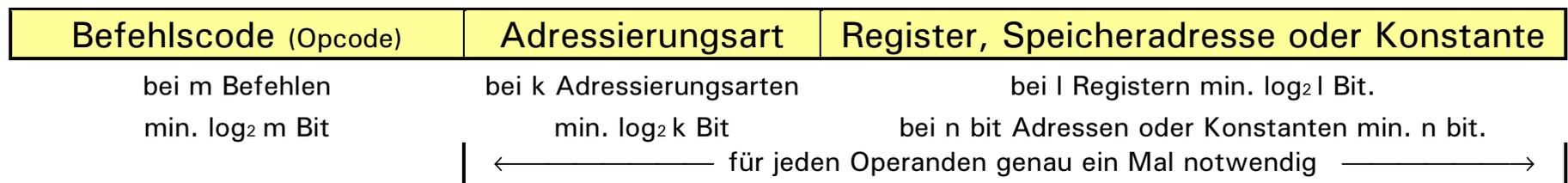
Befehle ohne Operanden oder mit Registeroperanden sind kürzer (meist **Ein-Wort-Befehle**) als Befehle mit Speicheroperanden oder Konstanten (**Mehr-Wort-Befehle**).
