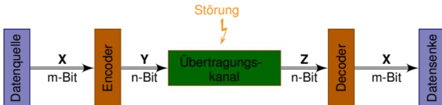
Fehlerfreie Übertragung:  $Z = Y$ , Fehlerhafte Übertragung:  $Z \neq Y$
